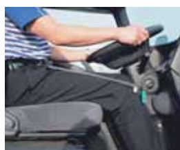
キー抜きによるアイドリングストップは、1997年より実施。キーを抜かなければ運転席を離れられない仕掛けとなっています。
